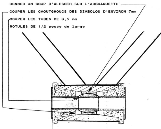
Il est également possible de limiter, en translation, la cage extérieure de la rotule, dans le A frame, par 2 circlips maintenus dans une gorge.
